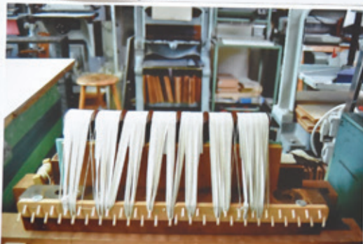
Nach dem Einletern wurde der fest verarbeitete Rücken mit den erhabenen Bänden abgebunden
