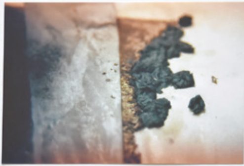
Mit Papierpulpe u. Hanffasern werden die Fehlstellen der Rippen ergänzt
